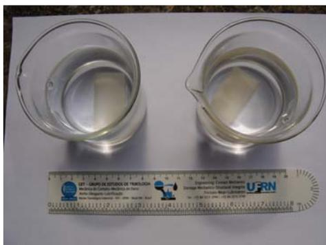
Figura 7 – Ensaio de absorção de água
