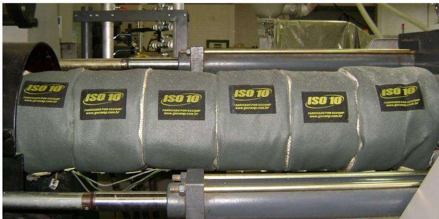
Figura 4 – Cilindro de plastificação com as mantas térmicas.
