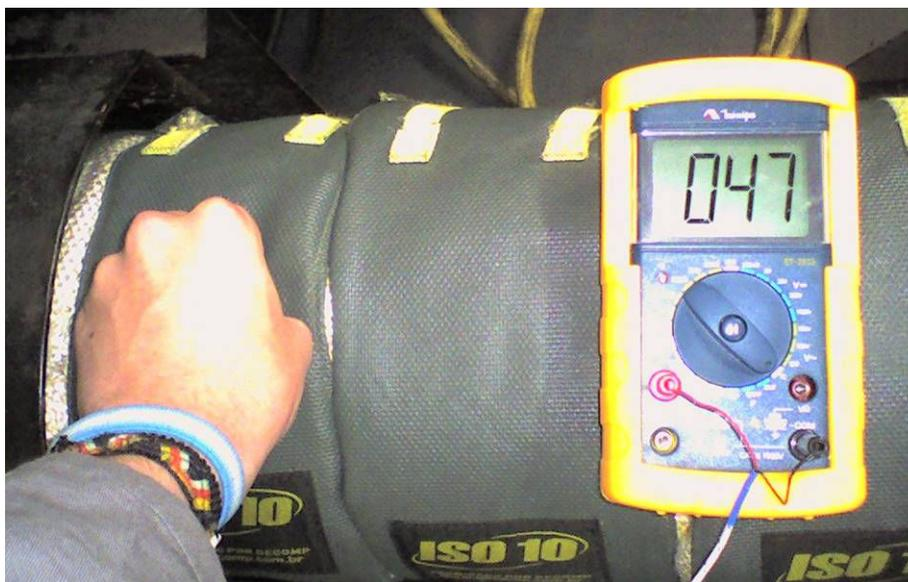
Figura 6 – Temperatura superficial com manta térmica.
