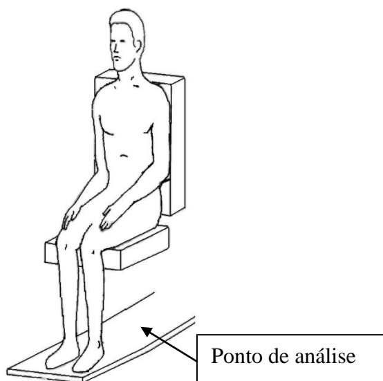
Figura 7. Representação da interface homem/veículo para posicionamento dos pontos de análise da resposta vibratória.
