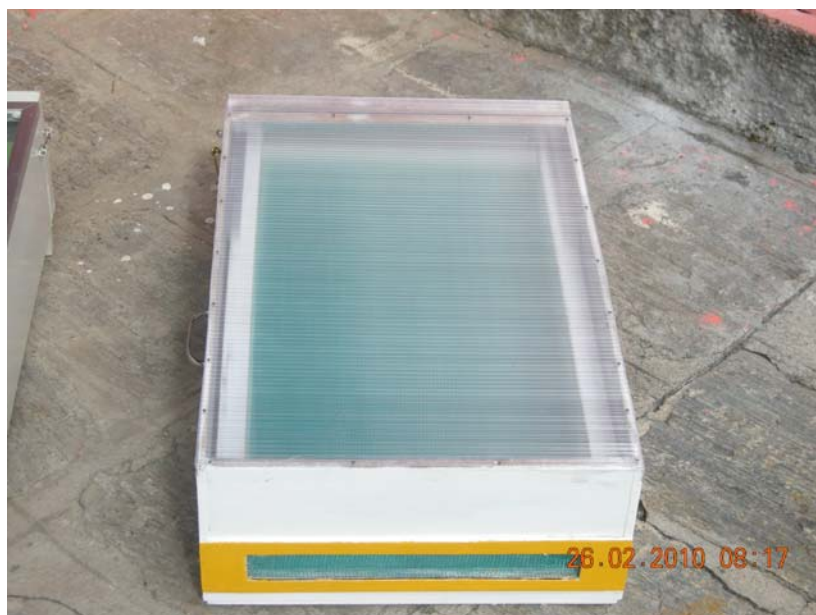
Figura 04. Foto do protótipo de secador solar com cobertura de policarbonato
