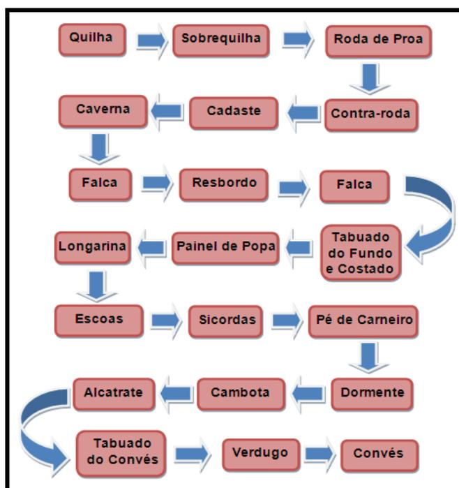
**Figura 6. Sequência de montagem das principais peças componentes de uma embarcação de madeira.**
