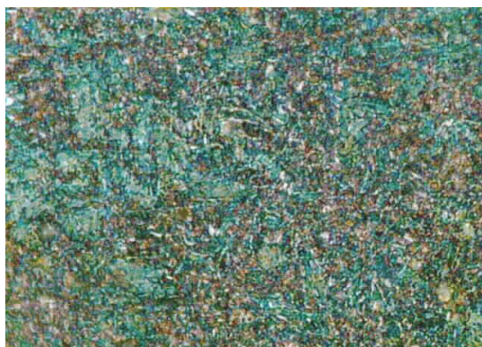
a. Percebe-se que a estrutura é composta principalmente de ferrita (azul-esverdeado).
