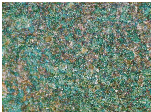
b. Estrutura predominantemente ferrítica
