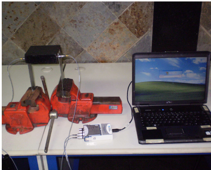
Figura 1. Sistema vibratório de 1 grau de liberdade.
