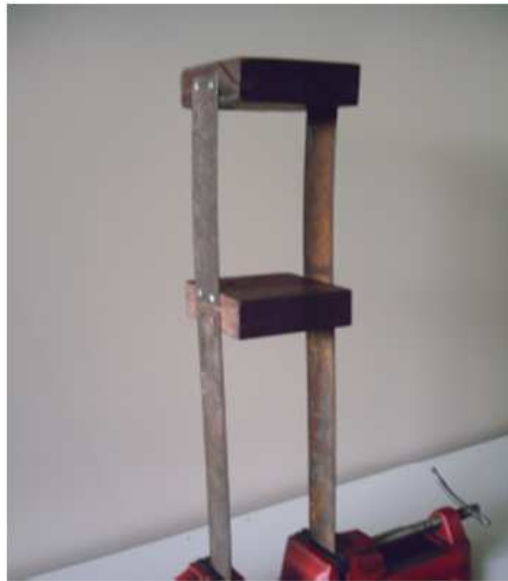
Figura 2. Sistema vibratório de 2 graus de liberdade.
