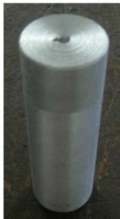
**Figura (3) – Lingote cilíndrico pré-usinado.**
