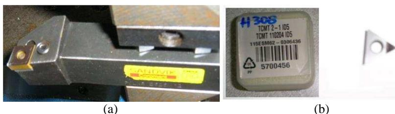
**Figura (5) – a) Ferramenta metal duro; b-) Ferramenta de diamante Policristalino.**
