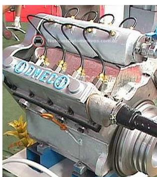
Figura 3. Foto ilustrativa do motor Brasileiro, movido a ar comprimido.
