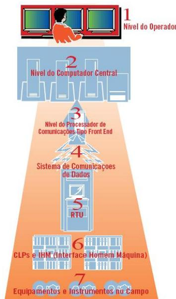
Figura 4 - Fluxo de comunicação entre o operador e os equipamentos e instrumentos de campo.
