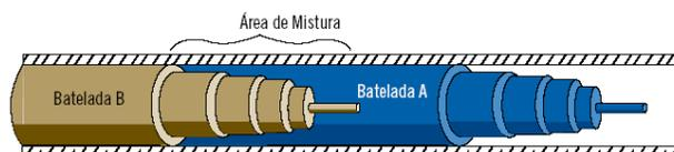
Figura 2 - Área de interface entre bateladas (mistura).
