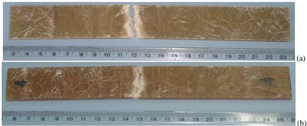
Figura 5. Corpos de prova após o ensaio de tração. a) laminado de fibra de vidro. b) laminado híbrido.
