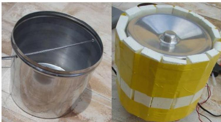
**Figura 4 – Recipiente de alum3nio utilizado (esquerda) e prot3tipo j3 isolado (direita)**
