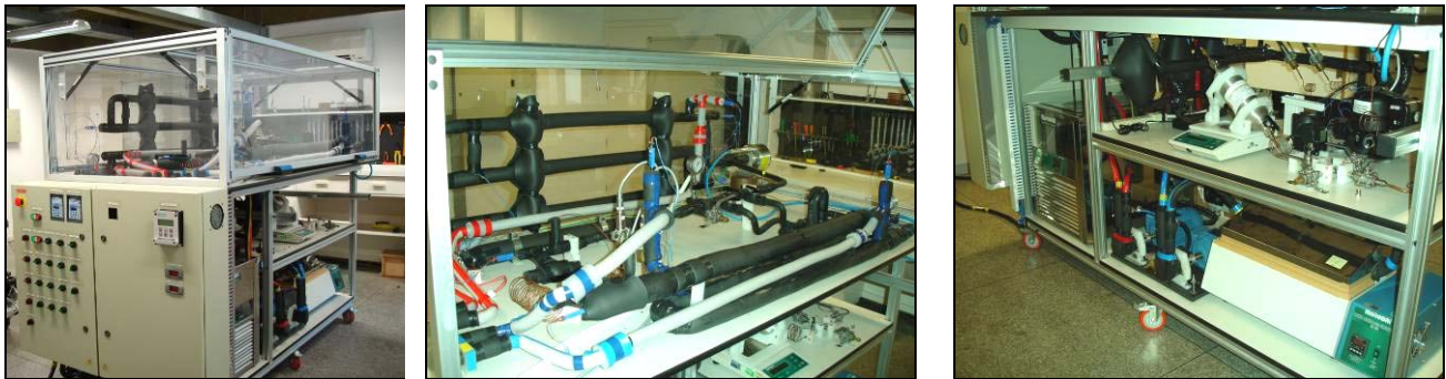
Figura 1. Fotos do aparato experimental. (A) visão geral, (B) bancada para montagem do ciclo, (C) unidades de condicionamento e bombeamento dos circuitos secundários
