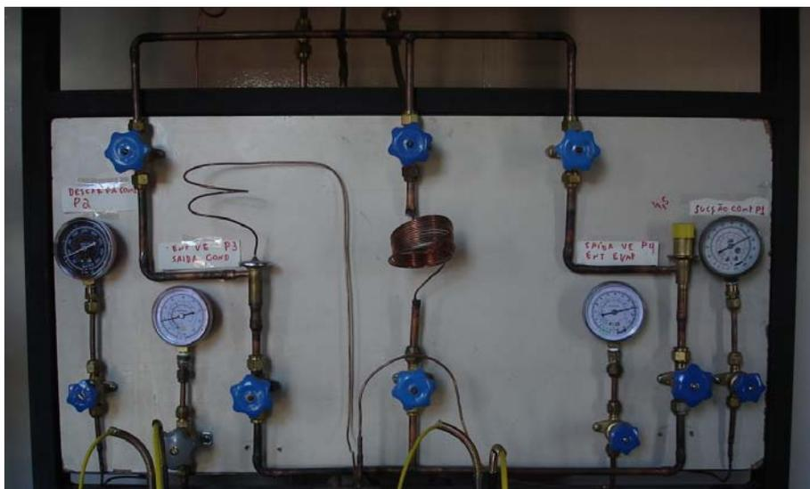
Figura 6. Seção dos dispositivos de expansão.
