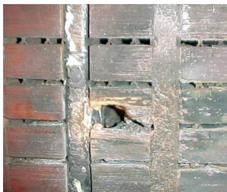
Figura 3. Fusão das lâminas do núcleo estatórico. (CESP, 2005)
