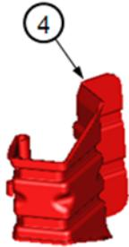
Figura 7 – Análise funcional da dobradiça móvel realizada na condição inicial da tampa
