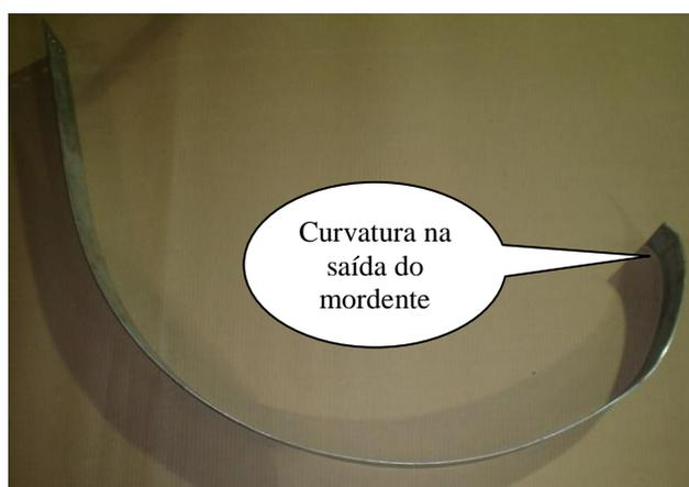
**Figura 9. Tira ensaiada com ângulo de abraçamento**
