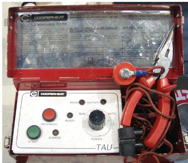
Figura 11. Sistema para soldagem por percussão (descarga capacitiva) para fixação dos termopares à peça.
