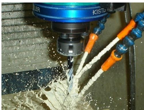
Figura 2. Aplicação de fluido de corte por jorro na vazão de 1200 l/h.
