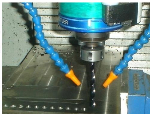
Figura 1. Aplicação de mínima quantidade de fluido de corte (MQF) na vazão de 50 ml/h.
