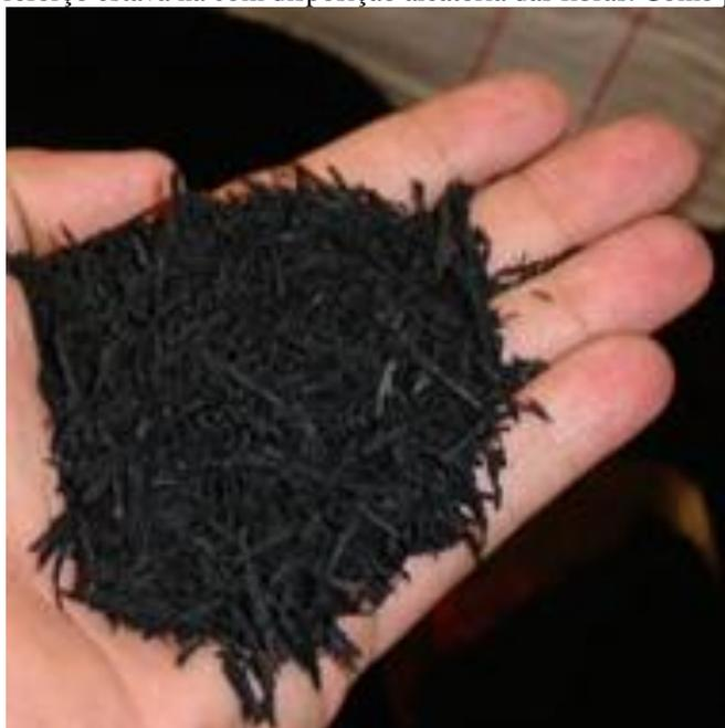
**Figura 1. Fibras de raspa pneu.**
