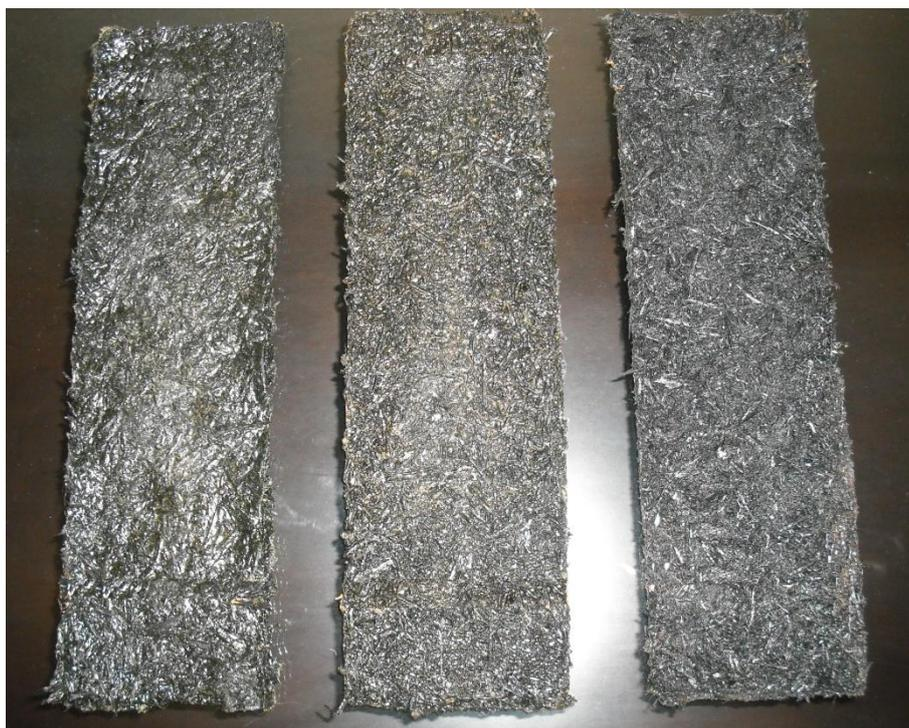
Figura 4. Compósito 1:2; 1:1 e 2:1 (raspa de pneu – látex) respectivamente.
