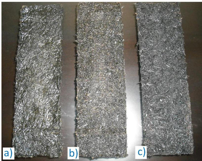
Figura 4. Compósito 1:2 (a); 1:1(b) e 2:1 (c) (raspa de pneu – látex) respectivamente.
