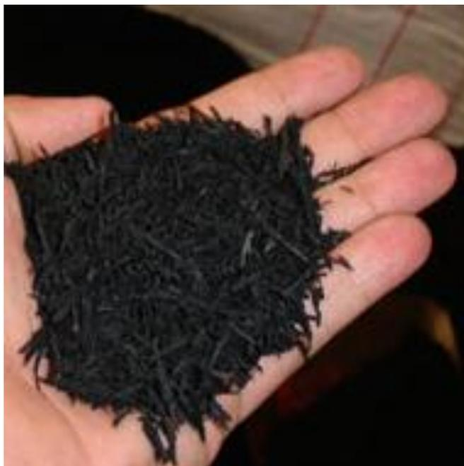
**Figura 1. Fibras de raspa pneu.**
