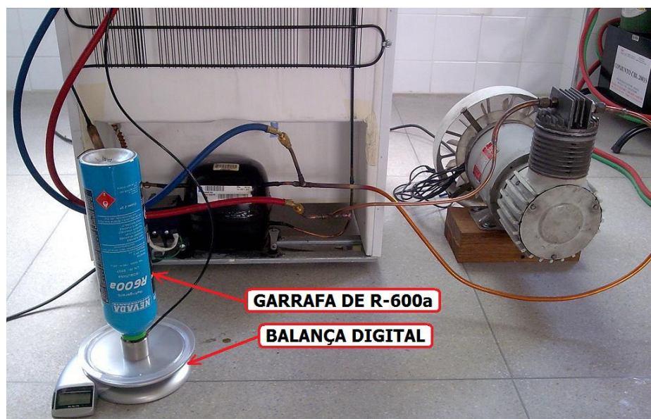
Figura 6. Foto de uma carga de fluido refrigerante. Fonte: Próprio autor (2009).
