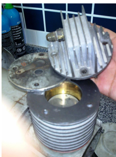
Figura 2. Detalhe do compressor isento de óleo durante a manutenção preventiva. Fonte: Próprio Autor (2009).
