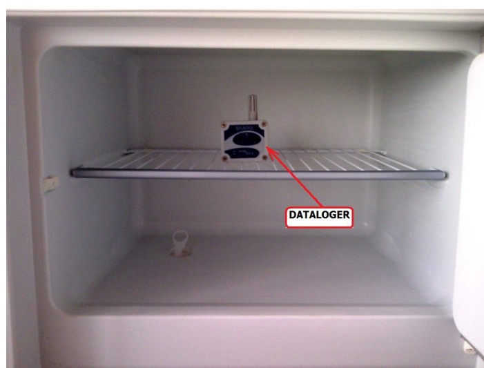
Figura 7. Foto de um Datalogger para registrar a temperatura interna do refrigerador. Fonte: Próprio autor (2009).
