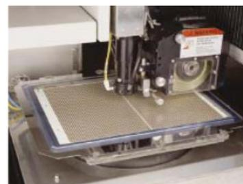
Figura 4 - Formatos admissíveis para corte em dicing machines inclinada – Série 7100 da *Advanced Dicing Technology* (ADT), (Disponível em: <<http://www.bitase1/datasheets/ADT-7100->
