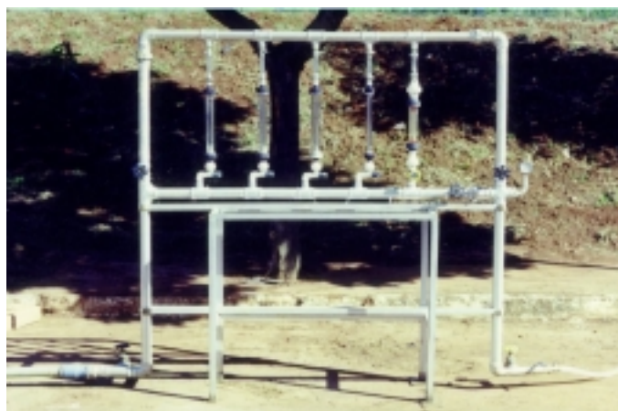
Figura 4 – Sistema de Controle das variáveis de escoamento.
