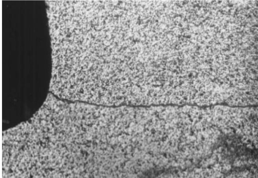
Figura 4. Ponto de iniciação da trinca – 200X (lado reverso) .
