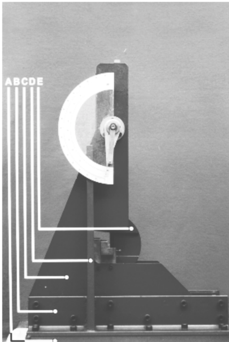
Figura 2.1 – Detalhamento construtivo da máquina de impacto para ensaios de ossos longos, com o martelo em posição de descanso. A – base de sustentação de toda a estrutura. B – cantoneiras. C – estruturas laterais. D – suportes laterais. E – disco do martelo .
