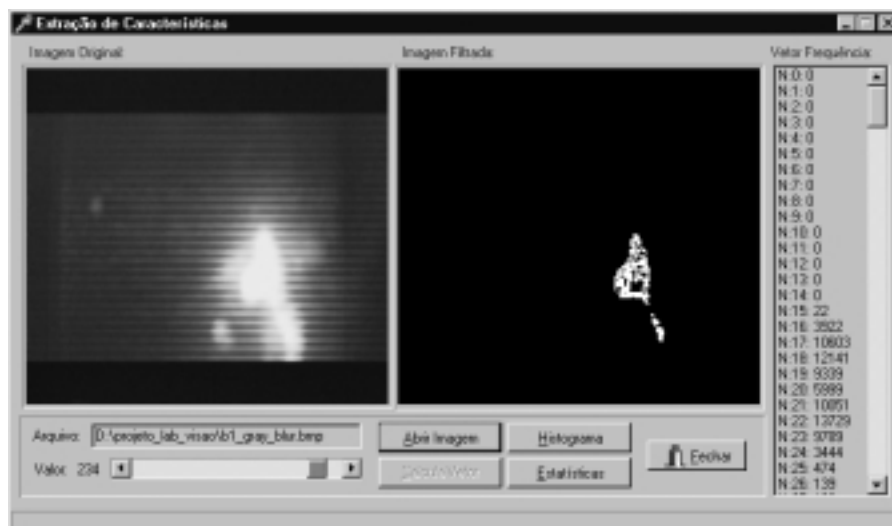
Figura 3. Interface para tomada de decisões. A imagem registra o momento da quebra da ferramenta com precisão de 1/60 segundos.
