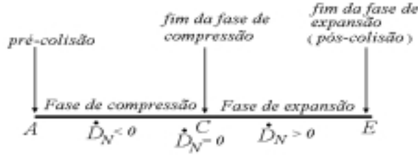
Figura 3: Fase de compressão e fase de expansão.
