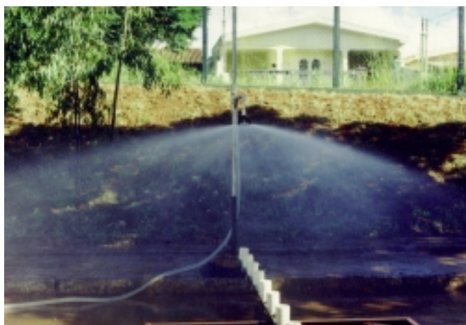
Figura 5 – Vista do conjunto, Sistema de Aspersão e de Medição.
