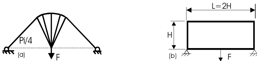
Figura 1. a) Estrutura de Michell e b) domínio inicial de projeto
