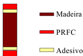
Figura 7. Seção transversal do estratificado utilizado na modelagem numérica.
