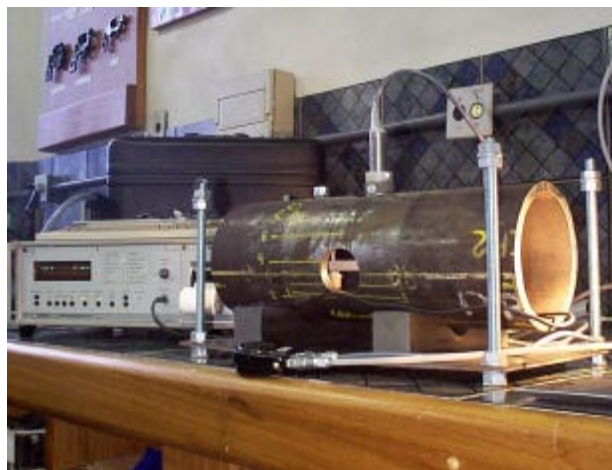
Figura 4 – Montagem do ensaio para medição interna e do sistema de aquisição de dados.
