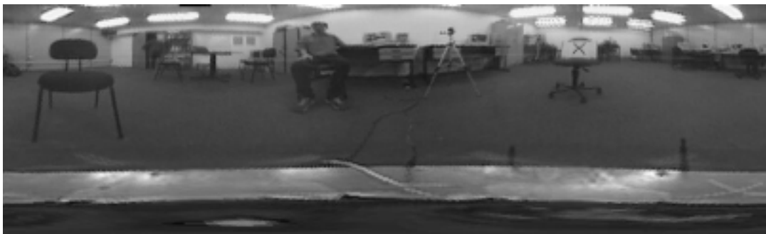
Figura 6. Imagem adquirida com o espelho esférico retificada pelo método de transformação direta de coordenadas
