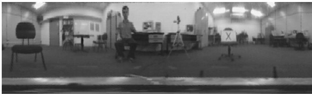
Figura 8. Imagem adquirida com o espelho hiperbólico retificada pelo método de transformação direta de coordenadas
