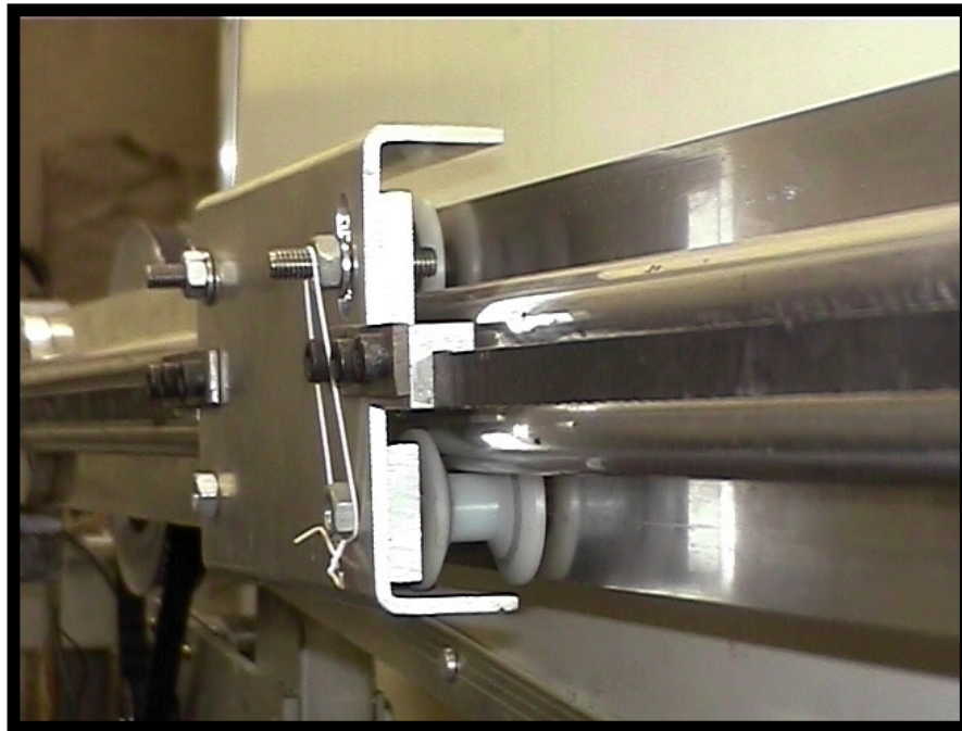
Figura 7 – Detalhe do carro e trilho do carro.
