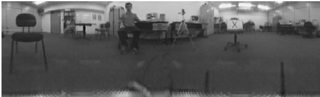
Figura 7. Imagem adquirida com o espelho hiperbólico retificada pelo método desenvolvido que leva em consideração a equação do espelho hiperbólico e a propriedade de centro único de projeção
