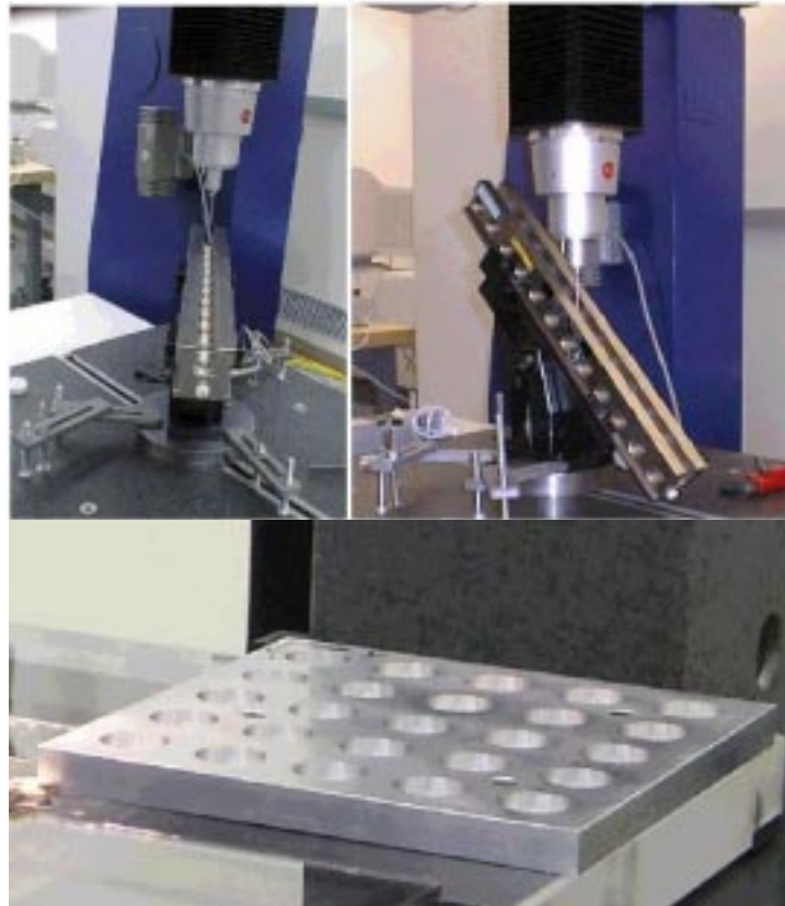
Figura 4: Outros Artefatos Padrões (Padrão Passo a Passo e Padrão Placa de Furos).
