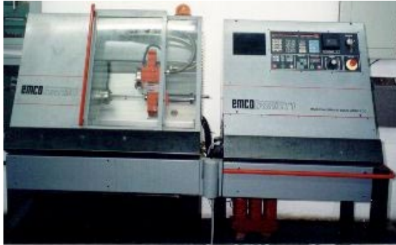
Figura 4 – Torno CNC EMCO-Turn 120 utilizado para a geração das superfícies analisadas e detalhe do corpo de prova.
