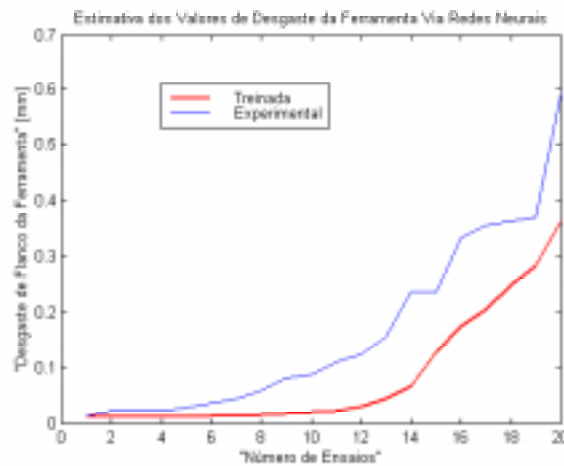
Figura 4. Ajuste dos valores de VB_{Bmax} realizado a partir do arquivo de dados originado pelas seis primeiras condições de corte da Tab. (1).
