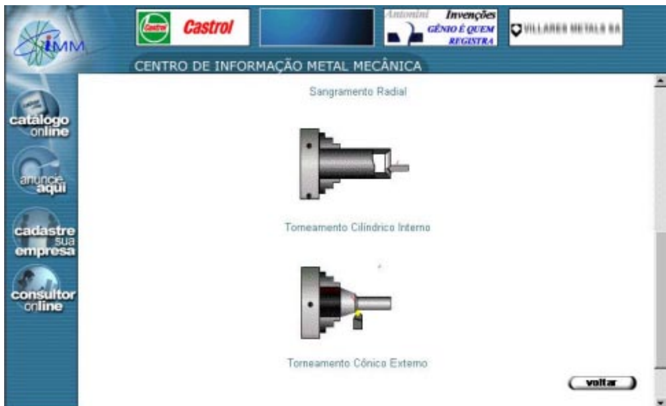
Figura 4. Imagens animadas que ilustram as operações de usinagem por torneamento cilíndrico interno (superior) e cônico externo (inferior).
