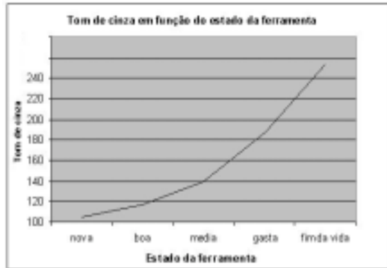
Figura 1. Tons de cinza em função do desgaste da ferramenta a 497 m/min (Borelli, 2000).
