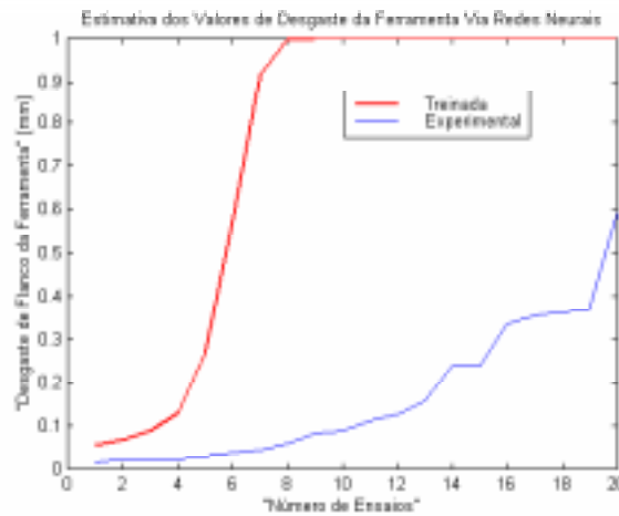
Figura 2. Ajuste dos valores de VB_{Bmax} realizado a partir do arquivo de dados originado pelas quatro primeiras condições de corte da Tab. (1).
