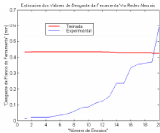
Figura 3. Ajuste dos valores de VB_{Bmax} realizado a partir do arquivo de dados originado pelas cinco primeiras condições de corte da Tab. (1).
