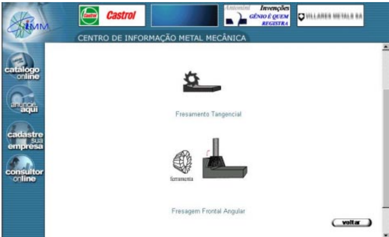
Figura 5. Imagens animadas que ilustram as operações de usinagem por fresagem tangencial (superior) e frontal angular (inferior).
