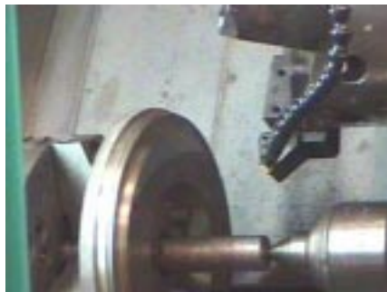
Figura 2. Montagem do ensaio experimental com MQL.
