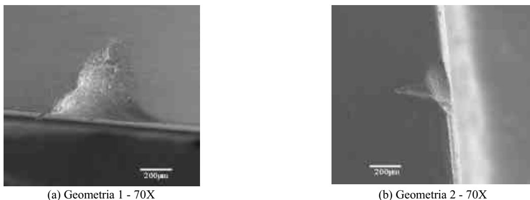
Figura 8. Condição de desgaste da ferramenta cerâmica CC650 após 24 segundos.
