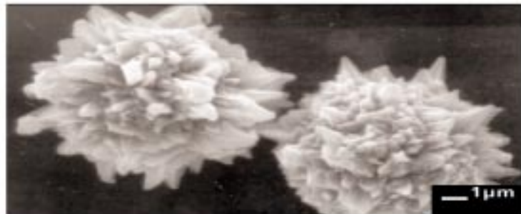
Figura 2: Micrografia do pó de Níquel 123, obtida por microscopia eletrônica de varredura.
