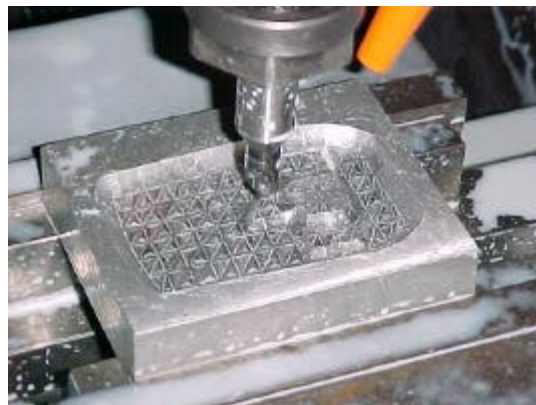
Figura 8. Peça na fresadora CNC, em seu segundo plano de desbaste.
