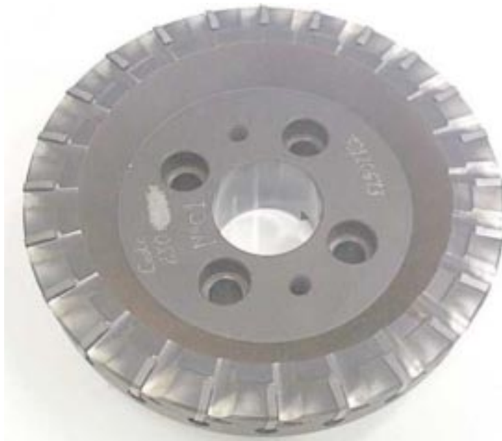
Figura 2. Fresa D250 mm– Sistema com todos os insertos alisadores.
