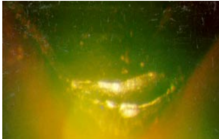
Figura 2. Forma de desgaste da ferramenta de corte. v_c=130\text{m/min} , f=0,07 mm/volta e a_p=0,2 mm (aumento 50 X).
