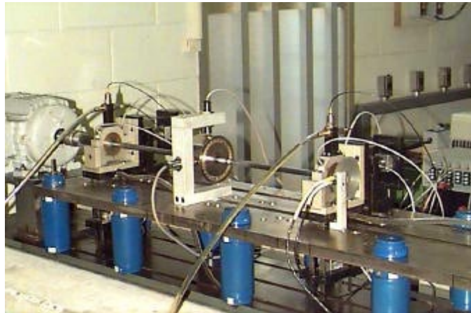
Figura 5. Bancada experimental com dois mancais hidrodinâmicos cilíndricos e uma massa.
