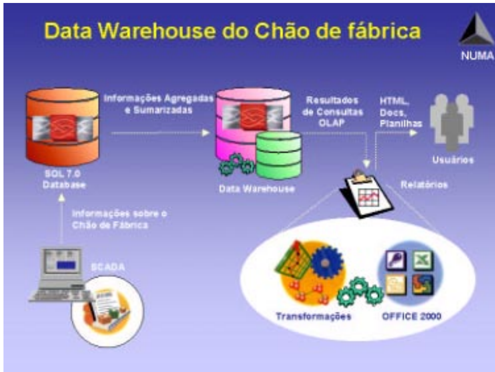
Figura 1. Esquema Representativo do Data Warehouse do Chão de Fábrica.
