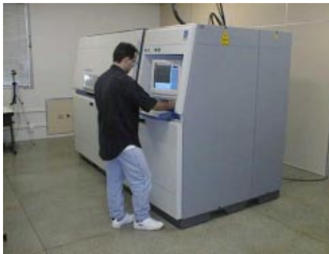
Figura 3. Máquina de prototipagem rápida Sinterstation 2000
