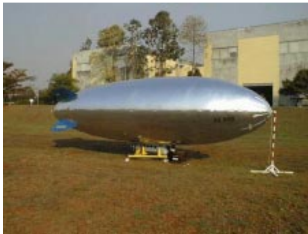
Figura 2. Dirigível não-tripulado AS800 pertencente ao CTI.
