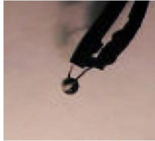
Figura 2: Fotografia do elemento sensor de formato esférico.
