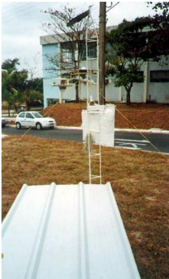
Figura 3. Visualização da telha metálica e da estação de medição próximas ao prédio em estudo.
