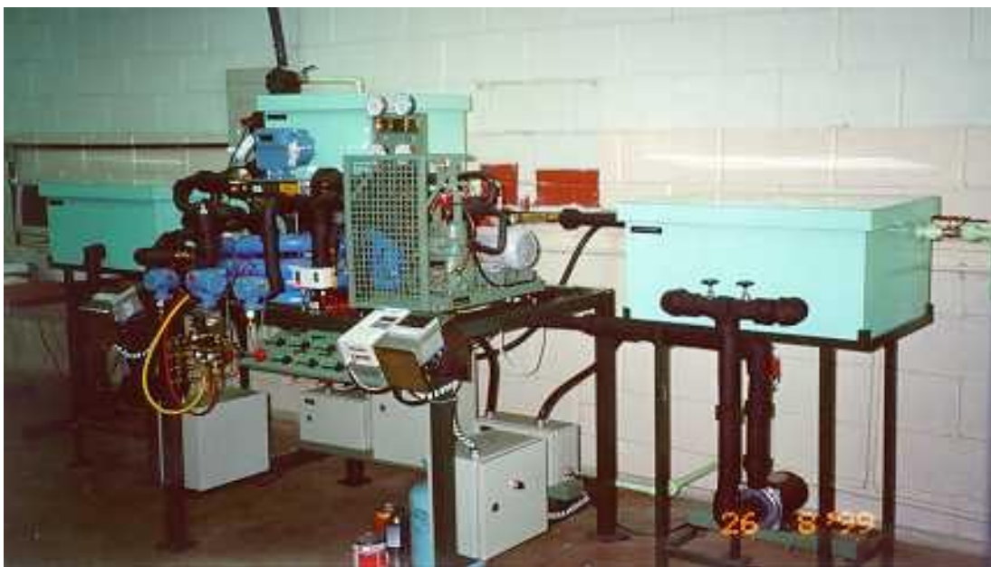
Figura 4. Fotografia do conjunto máquina frigorífica, fontes de calor e sistema de aquisição de dados.
