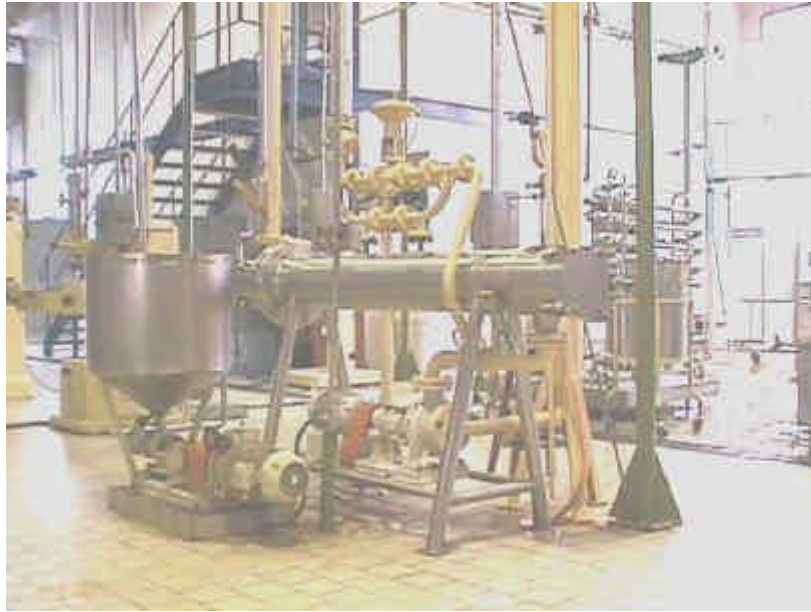
Figura 1. Trocador de calor feixe tubular instalado no Laboratório Integrado de Engenharia de Alimentos da E. E. Mauá.
