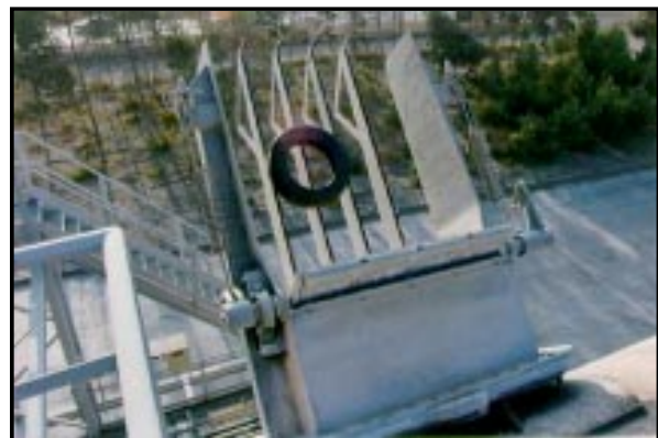
Figura 4. Instalação de válvula pêndulo no meio do forno – ERAtech - TMI Systems
