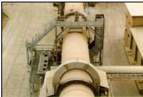
Figura 3. Sistema de introdução no meio do forno - ERAtech - TMI Systems
