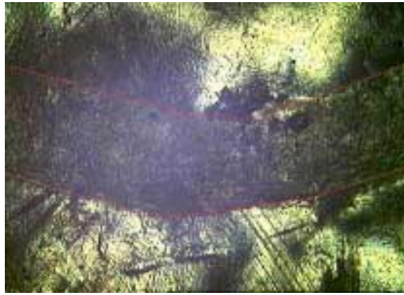
Figura 4 - Micrografia da trilha de desgaste do revestimento de PMMA com 50 m percorridos, utilizando uma lente de 50x. A trilha de desgaste é composta de sulcos.
