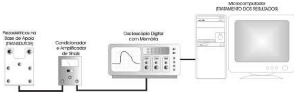
Figura 2. Sistema esquemático adotado na medição do sinal força-tempo.
