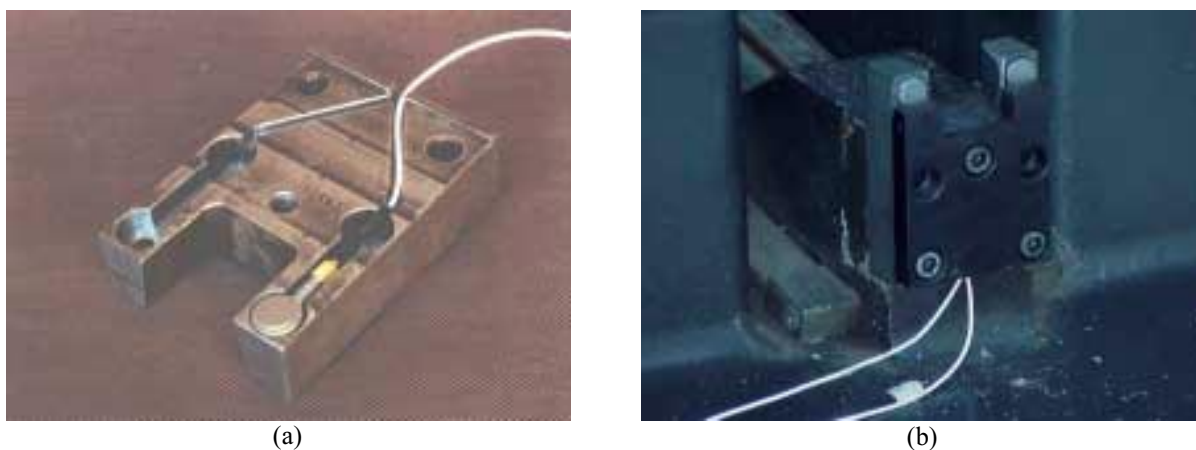
Figura 4. Nova base de apoio dos corpos de prova. (a) Detalhe do alojamento dos transdutores de impacto e (b) montagem da base de apoio modificada na estrutura da máquina Charpy.
