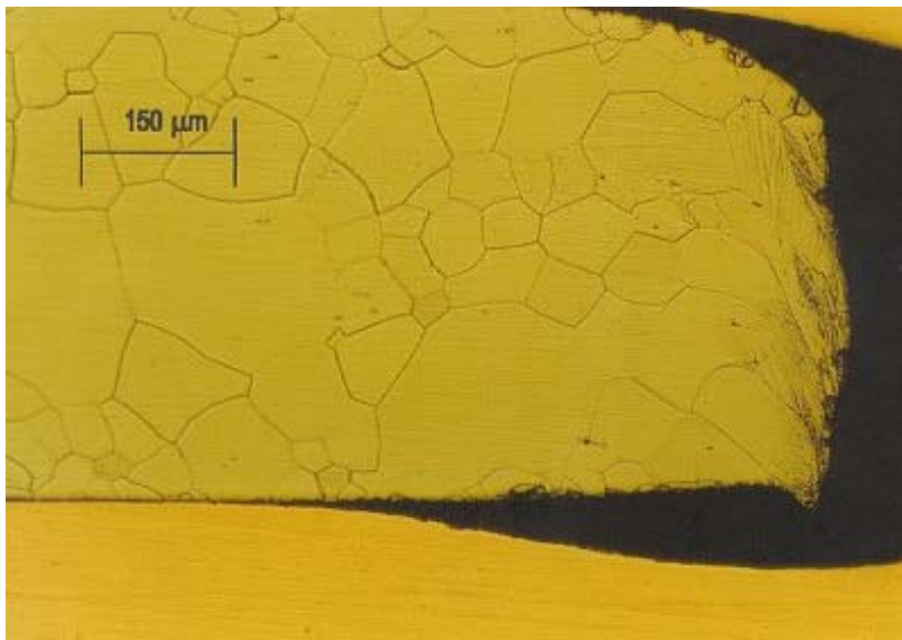
Figura 1. Representação das regiões deformadas de uma lâmina estampada.
