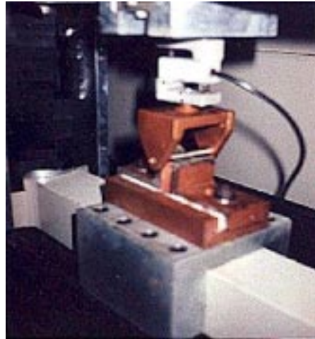
Figura 2. Mecanismo para o ensaio de flexão-em-três-pontos.
