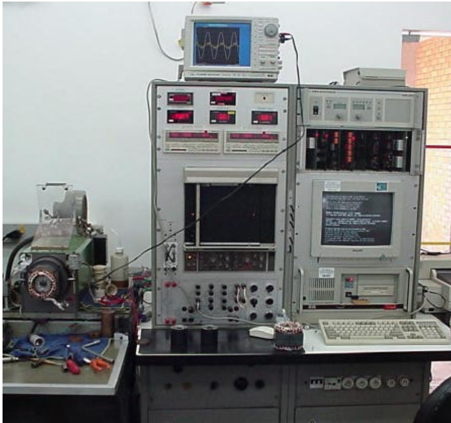
Figura 2 - Bancada para avaliação do desempenho de motores elétricos.
