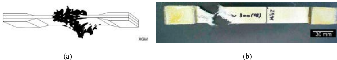
Figura 7. (a) Ilustração, de acordo com a norma ASTM D 3039 / D 3039M, do modo de fratura classificado como XGM (eXplosive, Gage, Middle) para o material compósito. (b) fotografia de um corpo de prova que sofreu fratura no ensaio de tração.
