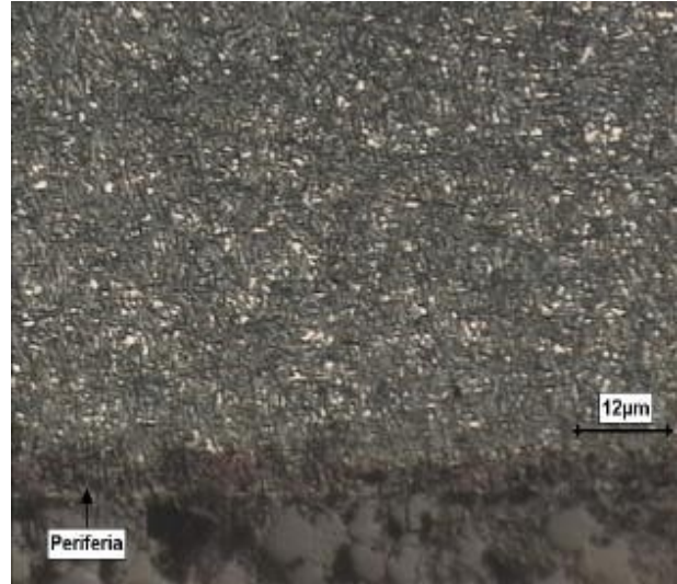
Figura 4. Micrografia da camada cementada do corpo de prova n.º 9 com ampliação de 200 x, ataque de nital a 3% - martensita e carbonetos.
