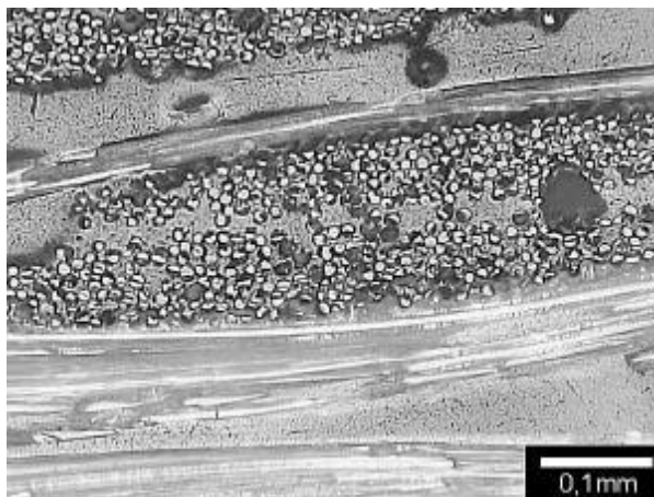
Figura 3. Micrografia ótica da seção longitudinal do compósito Fibra de Vidro/Epóxi. Homogeneidade microestrutural.
