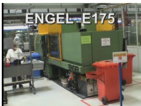
Figura 3: Máquina injetora na qual foi realizado o setup
