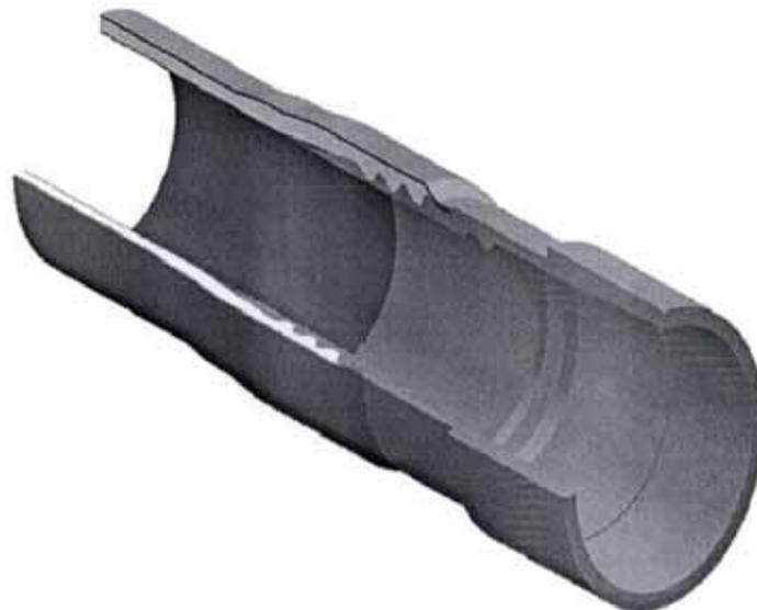
Figura 4. Interface compósito-metal de fechamento múltiplo do riser (Baldwin et al.<sup>(5)</sup>).
