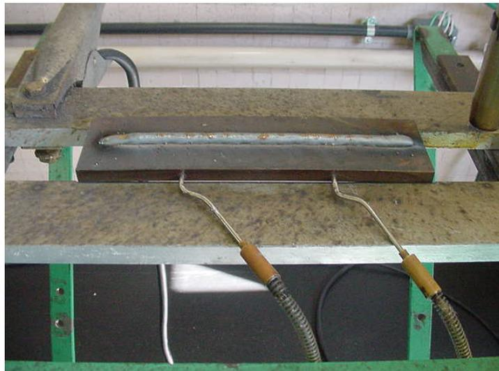
Figura 3. Placa com o cordão de solda depositado.
