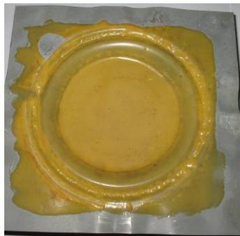
Figura 10. Filme sólido de poliuretano contínuo (sem rupturas), mesmo após a estampagem da chapa de aço DC 06
