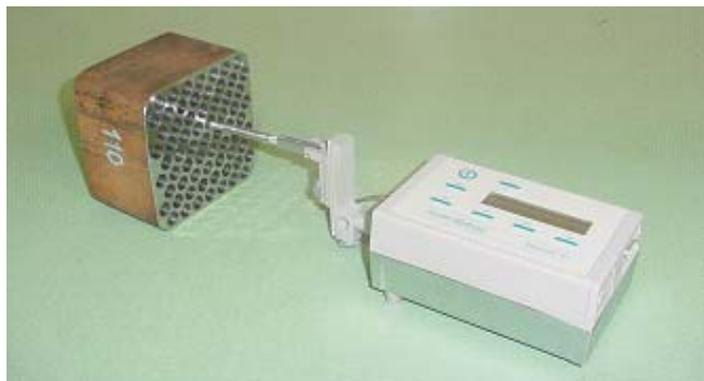
Figura 2. Rugosímetro portátil utilizado para medição de  $R_a$  em posição de medição
