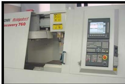
Figura 1. Centro de Usinagem vertical, modelo Discovery 760 (ROMI)
