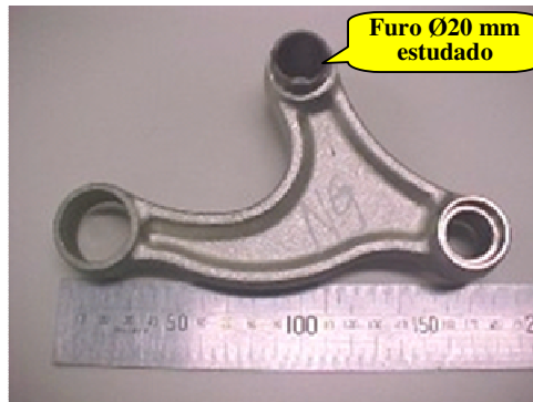
Figura 2. Braço de articulação forjado em aço ABNT 1045
