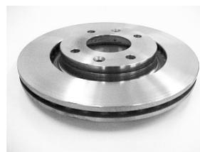
Figura 6 – Disco aletado usinado
