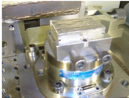
Figura 2 – Dispositivo de fixação do corpo de prova sobre o dinamômetro.
