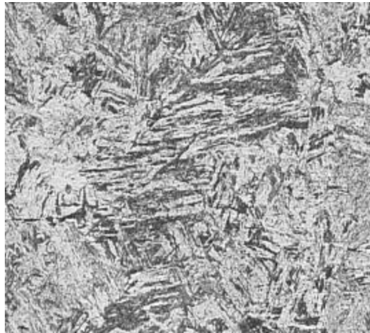
Figura 5 – Micrografia representativa da microestrutura martensítica presente em todos os cordões de solda (100X)
