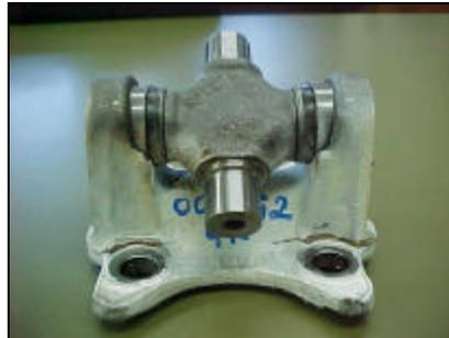
Figura 5: Imagem após o teste de fadiga – flange com raio de concordância modificado.
