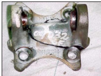
Figura 4: Estado do flange após aplicado o teste de fadiga dinâmica.
