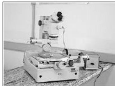
Figura 2 – MEV (esquerda) e Microscópio Ferramenteiro (direita).
