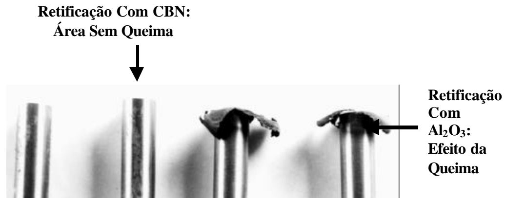
Figura 4- Comparação do comprimento de queima usando CBN e Al_2O_3 .
